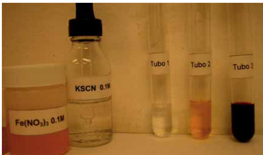
Figura 4. Identificación de hierro (III). El tubo 3 contiene el ion sulfociano hierro (III).
