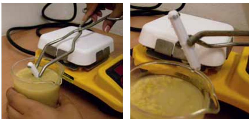
Figura 3. El hierro del cereal fortificado se puede recoger con una barra imantada.
